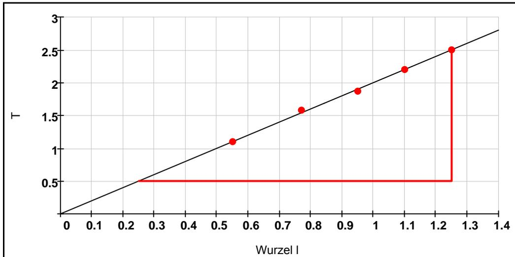
Die Messwerte liegen im Rahmen der Messgenauigkeit auf einer Ursprungsgeraden  $\Rightarrow T \sim \sqrt{l}$ .
