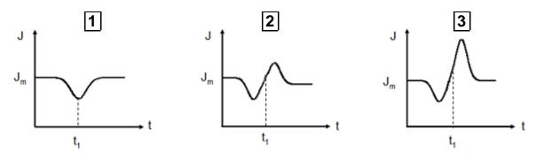
Beim Eintritt des Weicheisenkerns ( $\mu_r >> 1$ ) in die Spule wird der magnetische Fluss größer.
